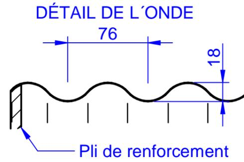
Epaisseur de la tôle 0.6 mm. et 1,2 mm. pour les bords.
