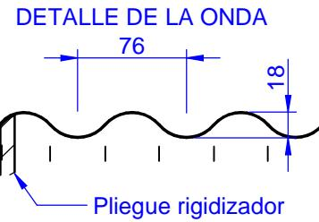
Espesor de la chapa 0.6mm
