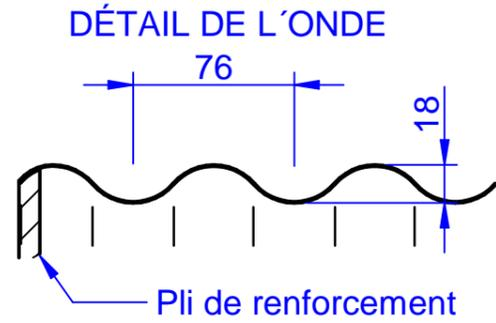
Epaisseur de la tôle 0.6 mm. et 1,2 mm. pour les bords.
